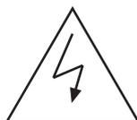
Этот символ, расположенный на корпусе или внутри устройства, служит предупреждением о присутствии опасного для жизни напряжения.
