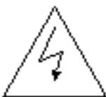
Этот символ на внешней поверхности или внутри оборудования предупреждает об опасном высоком напряжении.
