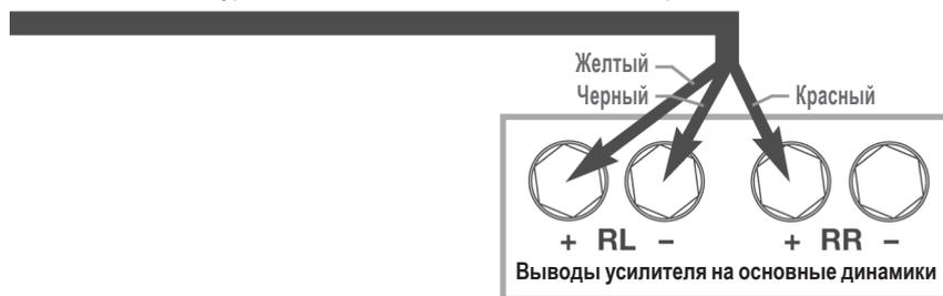
Низкоуровневое подключение (через разъемы RCA) всегда доступно для использования, если невозможно высокоуровневое подключение. При подключении к низкоуровневым входам в системе, с которой невозможно использовать высокоуровневое подключение, как, например, при подключении акустической системы со встроенными усилителями, соедините посредством кабеля RCA разъемы jack НИЗКОУРОВНЕВОГО ВХОДА системы REL с выводами левого и правого каналов на вашем предусилителе.
