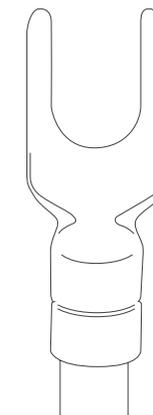
Подключите кабель заземления кабеля тонарма наконечником к гнезду заземления предусилителя или усилителя. При этом учитывайте требования инструкции по эксплуатации усилителя.
